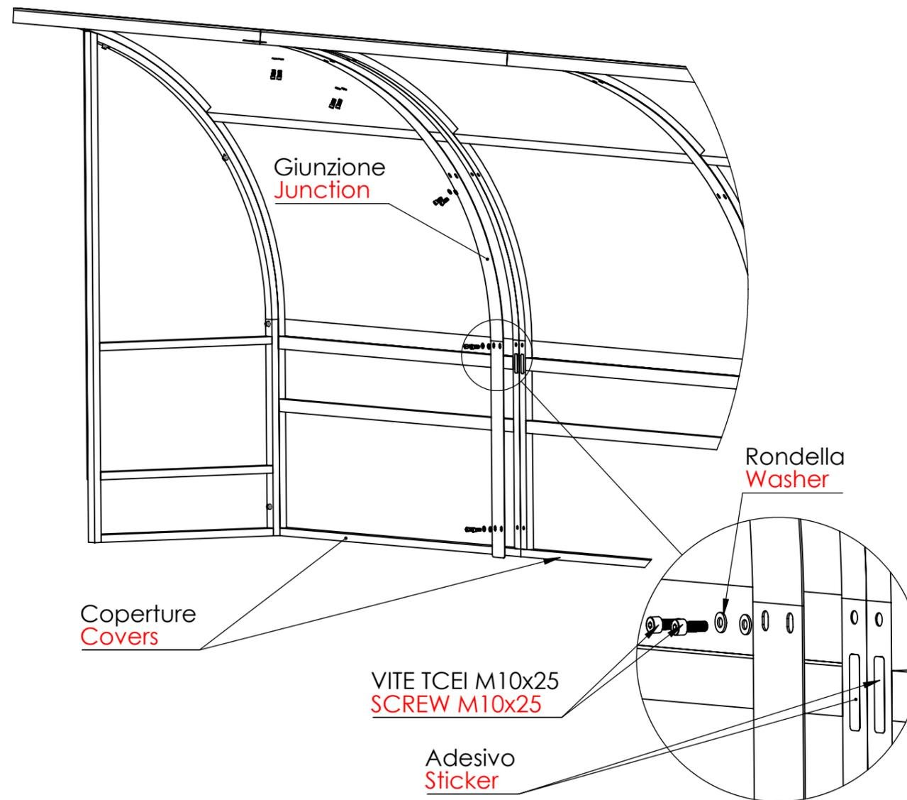
ACOSTARE LE COPERTURE, SOVRAPPORRE L'ELEMENTO DI GIUNZIONE E SERRARE CON VITI TCEI M10x25 E RONDELLA.
