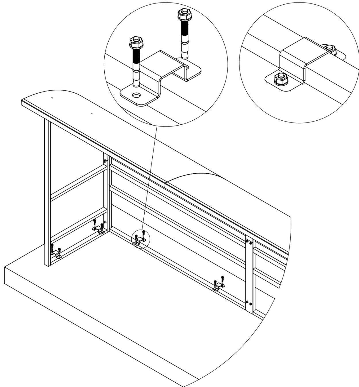
Ancorare le staffe di fissaggio a terra mediante n°4 tasselli specifici al tipo di pavimentazione a distanza di al massimo 80cm.
